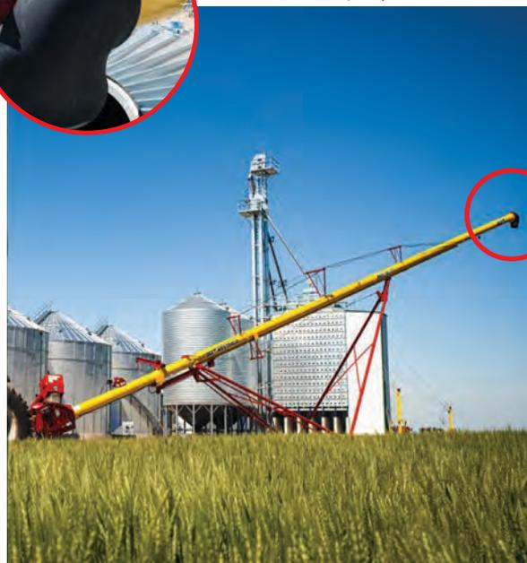
Options : Entraînement hydraulique (HD) ou à courroies (BD) ou à moteur électrique (EMD) ou à prise de force (SD) ou à moteur à essence (MD). Trémie de plastique ou d'acier offert en option.
